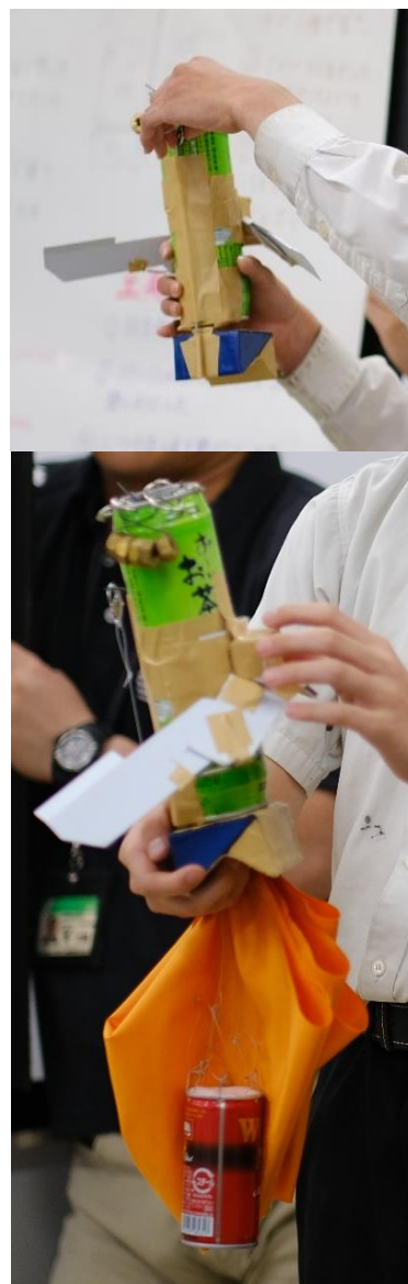
図5 開閉式の蓋と翼を搭載した缶サット
