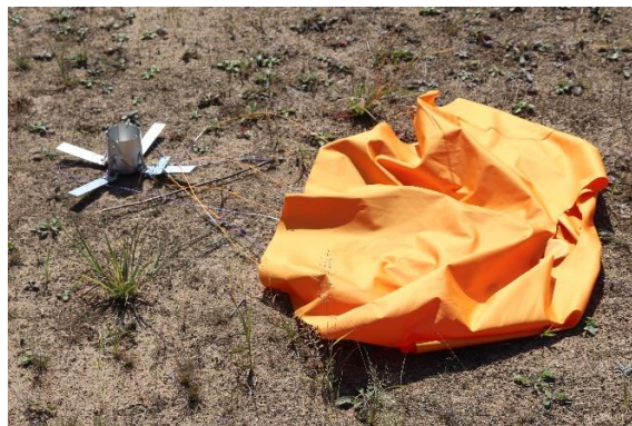
図8 缶の高さが低く脚が開く機構を搭載した缶サット
