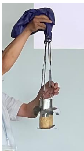
図 9 羽根を付け紐は硬くした缶サット
