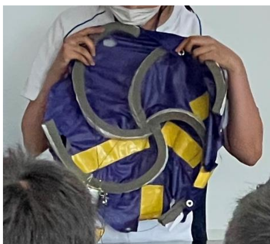
図 10 パラシュート裏にスポンジを付け気流を調整した缶サット
