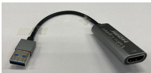
オンライン会議でホームビデオカメラを使用したいときに使います。HDMI端子はカメラと接続、USB端子はPCのポートに挿し込んで使用します。
