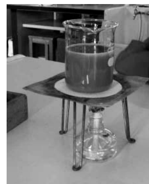
写真3 サーモインクによる実験 最初は青色で、約40℃を超えるとピンク色になる。
